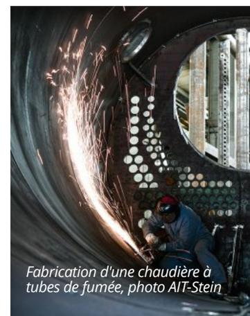
Fabrication d'une chaudière à tubes de fumée, photo AIT-Stein
